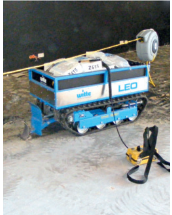
Der Raupenstripper wird mit einer kabelgebundenen Fernsteuerung geführt.
