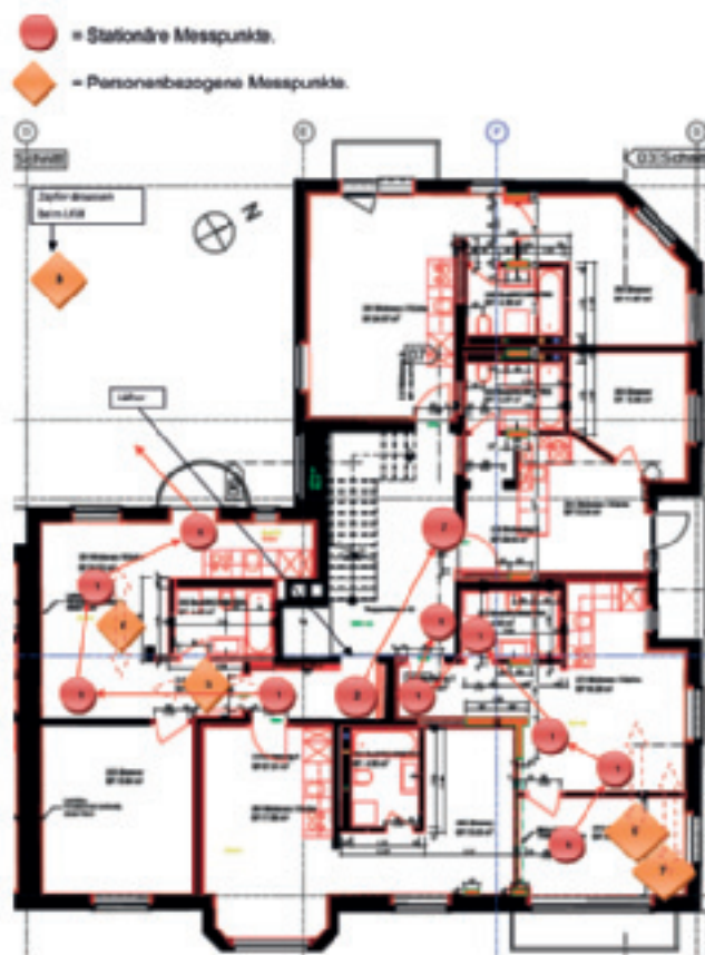
Grundriss des Gussasphalt-Einbauorts in einer Wohnliegenschaft in Zürich. Anlässlich der Versuchsreihe wurden zahlreiche stationäre und personenbezogene Luftmessungen durchgeführt und akribisch protokolliert.
